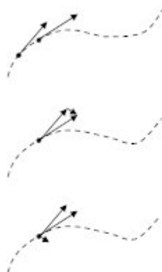
Gráfico N° 4: Partícula acelerada y secuencia de pasos para determinar su aceleración.
